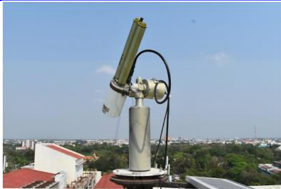
รูปที่ 4 เครื่องเซ็นโฟโตมิเตอร์ ที่ติดตั้งบนดาดฟ้าชั้น 11 มหาวิทยาลัยศิลปากร จังหวัดนครปฐม
