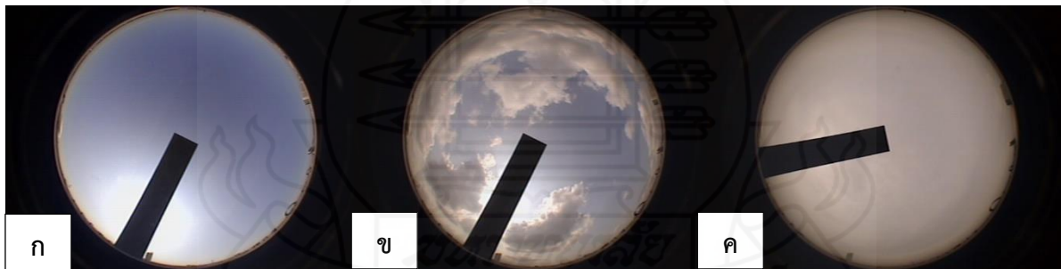
รูปที่ 3 ตัวอย่างภาพถ่ายท้องฟ้าจากเครื่องถ่ายภาพท้องฟ้า (sky view) ก) กรณีสภาพท้องฟ้าปราศจากเมฆ (clear sky) ข) กรณีสภาพท้องฟ้ามีเมฆบางส่วน (partly cloudy sky) ค) กรณีสภาพท้องฟ้าปกคลุมด้วยเมฆทั้งหมด (overcast sky)
